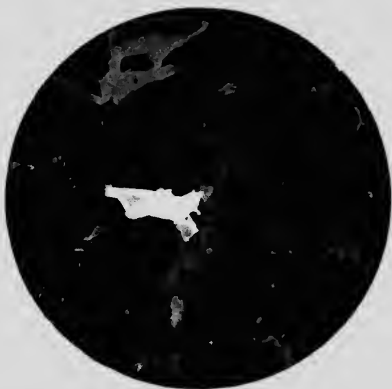
Microphotographie montrant la présence d'un diamant dans des veinules traversant la chromite. Grossissement, 25 diamètres.
